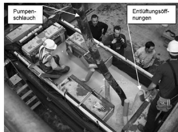
Durchführung der umfangreichen Pumpversuche im Betonierkeller der Materialprüfungs- und Forschungsanstalt, Karlsruhe (Foto: Institut für Massivbau und Baustofftechnologie)
