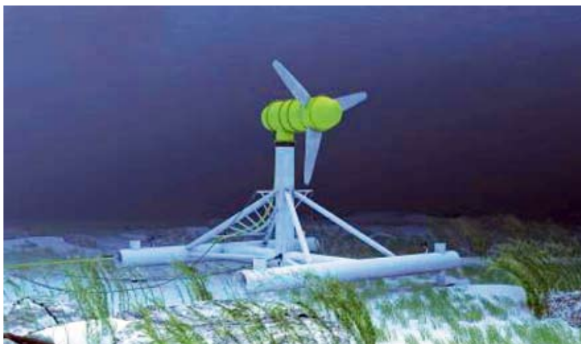
Die Meeresströmungsturbine zeichnet sich durch robustes Design ohne Getriebe und Rotorblattverstellung sowie Umweltfreundlichkeit durch Vermeidung von Ölen und vollständiger Installation unter Wasser aus.
