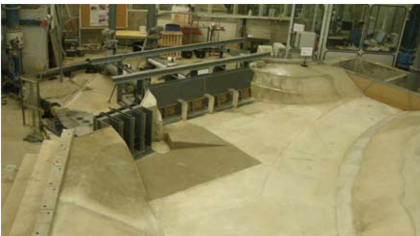
Das wasserbauliche Modell im Maßstab 1:25
